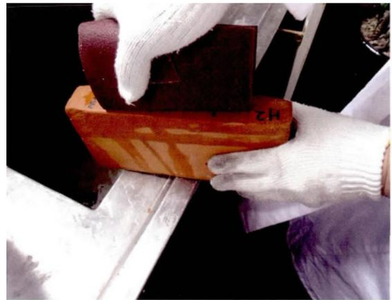
图 7 砂纸打磨砖表面
