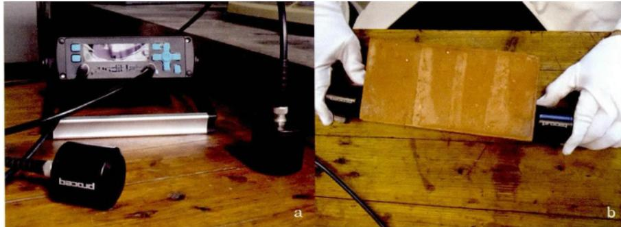
图 3 瑞士 Proceq 超声波检测仪(2.5W 500mh 5V)与采用直接测量法检测波速
