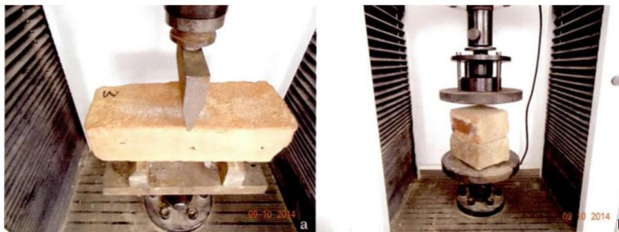
图 5 参照文献[1]测定香港某古建筑砖的抗折(a)与抗压(b)强度
